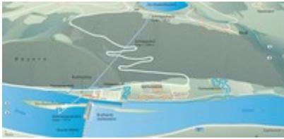
Pumpspeicherkraftwerke stellen wertvolle Regel- und Ausgleichsenergie als Beitrag zur Versorgungssicherheit zur Verfügung. Sie sind die beste Möglichkeit, Strom in großen Mengen zu speichern und die Stromnetze zu stabilisieren – beides wichtige Parameter für das Gelingen der Energiewende.
