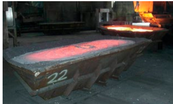
Abb. 2-4: Abstich des glutflüssigen Rohsiliziums (linkes Bild) und auskühlendes Roh-Silizium kurz nach dem Abstich bei über 1.600 °C (rechtes Bild)
