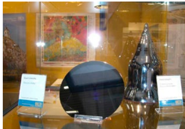
Abb. 2-6: Ein gezüchteter Silizium-Einkristall (rechts im Bild) und ein daraus geschnittener Silizium-Wafer (im Vordergrund)
