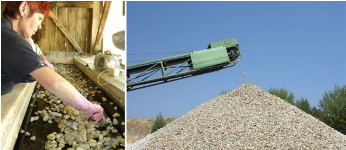
Abb. 5-2: Handverlesung und Lagerung von Quarzkiesen zur Rohsiliziumherstellung in der Kiesgrube Nr. 7 Jederschwing II a
