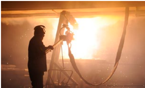
Abb. 2-4: Abstich des glutflüssigen Rohsiliziums (linkes Bild) und auskühlendes Roh-Silizium kurz nach dem Abstich bei über 1.600 °C (rechtes Bild)
