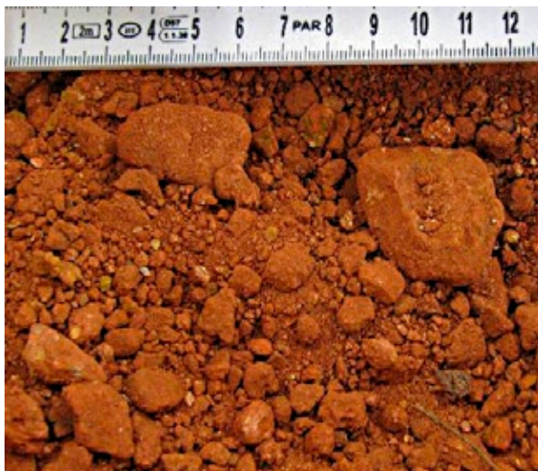
Abb. 5-7: Lateritroter Abschnitt in ca. 20,1 m Tiefe (Bohrung W34).
