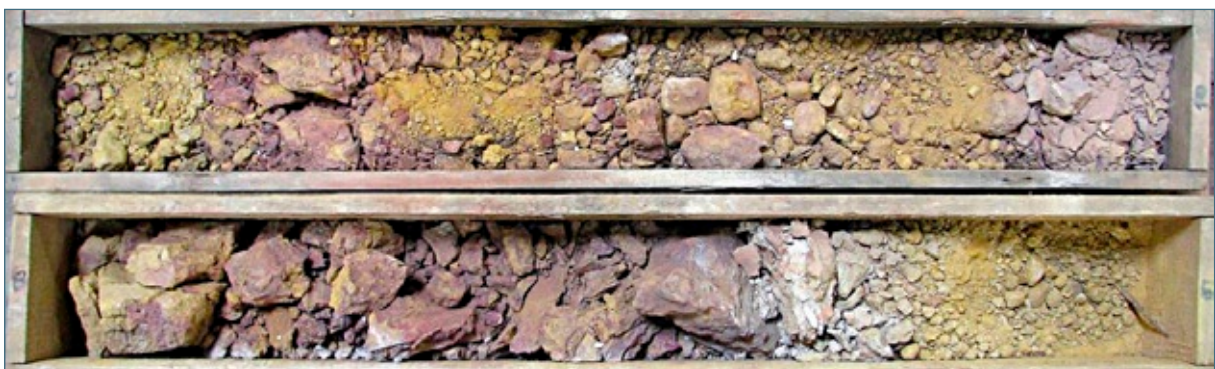
Abb. 5-14: Bohrmeter 8 – 10, rosa-violetter und gelber Sand und Kies (W18).
