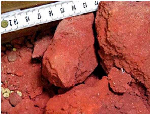
Abb. 5-13: Lateritrote Fein- bis Mittelsande in 6,2 m Tiefe (W18).
