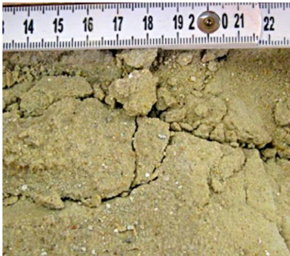
Abb. 5-26: Hellbrauner Fein- bis Mittelsand, muskovitführend, aus 25,3 m Tiefe (W27).
