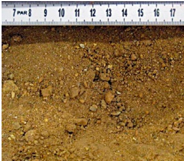
Abb. 5-19: Ockerfarbener, schwach kiesiger Sand aus 3,7 m Tiefe (W10).
