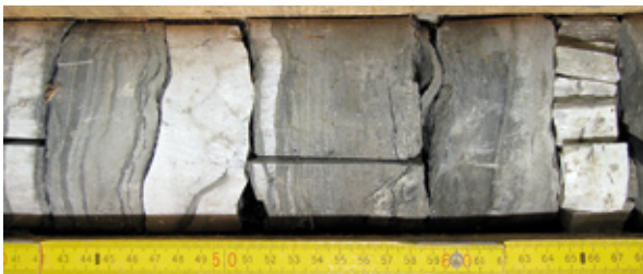
Abb. 4-17: Lagen von Fasergips. Gips 2, Bindlach: 99,4 m - 99,7 m
