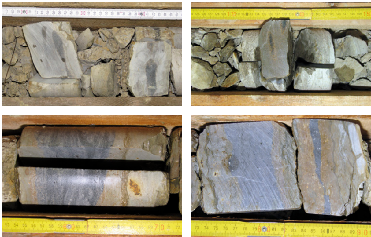
Abb. 4-9: (links-oben): Hornsteinlagen, Gi. 13, Ahlstadt, 43,3 m - 43,5 m; (rechts-oben) Hornsteinlagen, Gi. 11, Gössersdorf, 34,7 m; (unten) Hornsteinlagen, Gi. 1, Ützdorf/Döhlau, 45,6 m und 49,8 m
