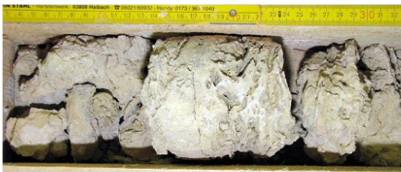
Abb. 4-6: Laugungsbrekzie (Detail) mit unvollständigem Kerngewinn, Bohrung Gips 9, Benk, 29 m - 29,3 m
