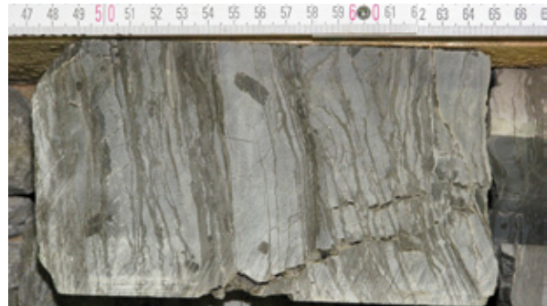
Abb. 4-12: Laminierter Sulfat. Gips 13, Ahlstadt, 86,5 m - 86,65 m
