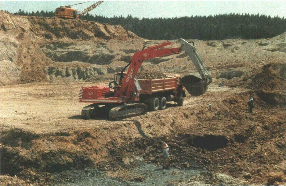
Foto 1. Ehemalige Bentonitgrube Sallmannsberg bei Landshut; Die Dachfläche des etwa 1,5 m mächtigen, gelbbraunen Bentonites liegt frei (Standort rechter Arbeiter); Liegendes: blauer, toniger Mergel (Standort linker Arbeiter); Hangendschichten: vorwiegend Kiese und Sande (ca. 25 m mächtig). – Aufnahme: Südchemie AG, München, 1982. – Heutiger Grubenzustand: verfüllt, rekultiviert, teils Schwalbenbiotop.
