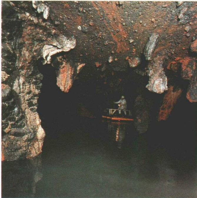
Foto 2. Sinkwerk im Salzbergwerk Berchtesgaden/Obb.; Ausschnitt eines Sinkwerkhimmels im Rotsalzgebirge mit Anhydrit und Polyhalit. — Aufnahme: Salzbergwerk Berchtesgaden 1987.
