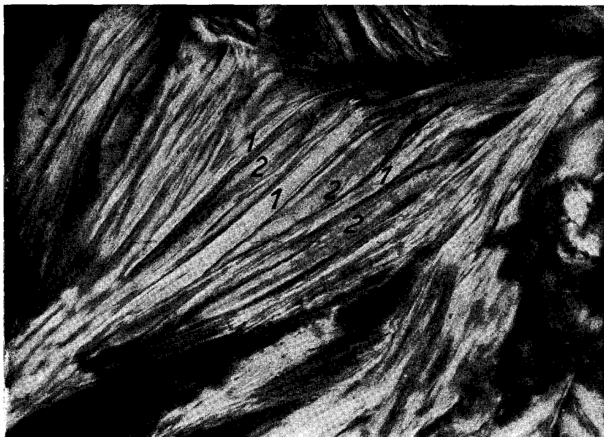
Abb. 36. Parallelverwachsungen von Muscovit (1) und Chlorit (2) in einem Zwickel des sphärolithischen Quarzporphyrs. Johanneszeche. \times Nicols, 630-fache Vergrößerung.
