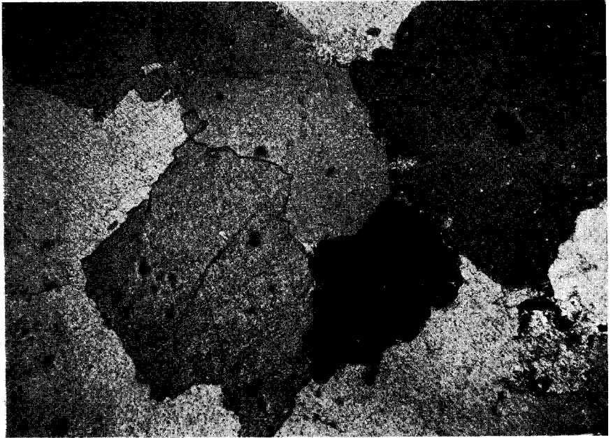
Abb. 14. Metasomatisch aus Calcitmarmor gebildeter Dolomit. Johanneszeche. \times Nicols, 52-fache Vergrößerung.
