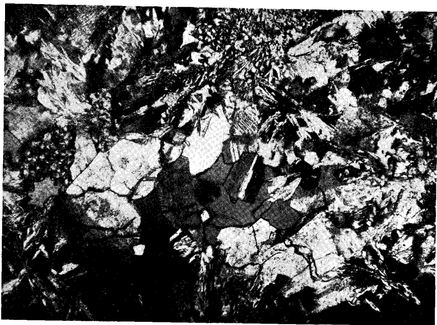
Abb. 10. Zwickelfüllung im sphärolithischen Quarzporphyr mit Albit und Quarz. \times Nicols, 52-fache Vergrößerung.
