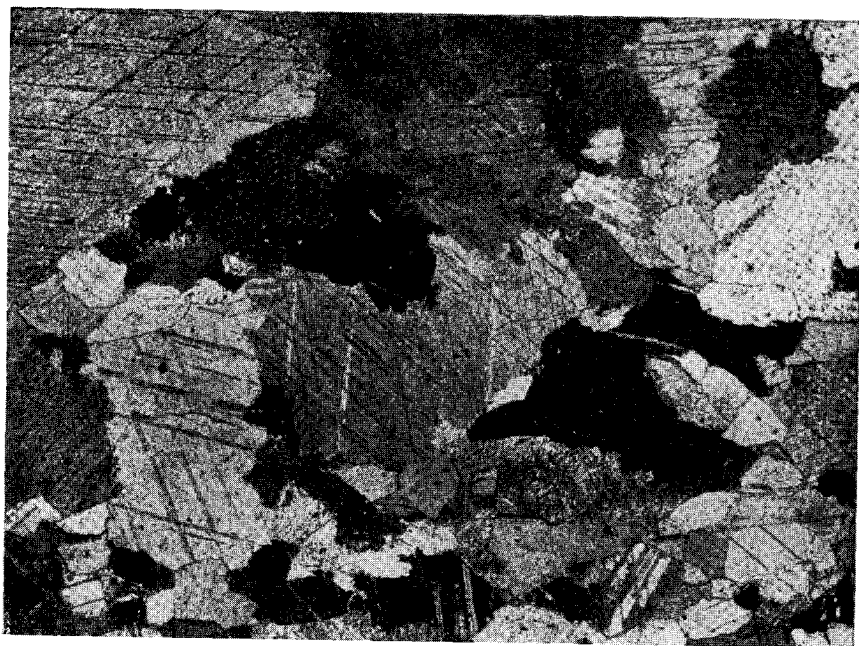
Abb. 3. Calcitmarmer von Sinatengrün. \times Nicols, 52-fache Vergrößerung.
