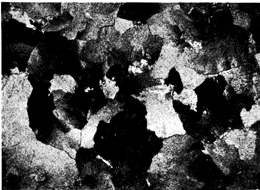
Abb. 16. Dolomitneubildung in einem Lösungshohlraum des Dolomitmarmors (Johanneszeche). Die einzelnen Dolomitkörner löschen nicht einheitlich aus. \times Nicols, 52-fache Vergrößerung.
