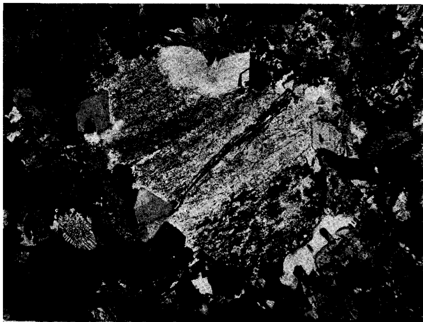
Abb. 12. Karbonateinschluß mit Reaktionsbildungen im granophyrischen Quarzporphyr. Höchstädt. \times Nicols, 70-fache Vergrößerung.
