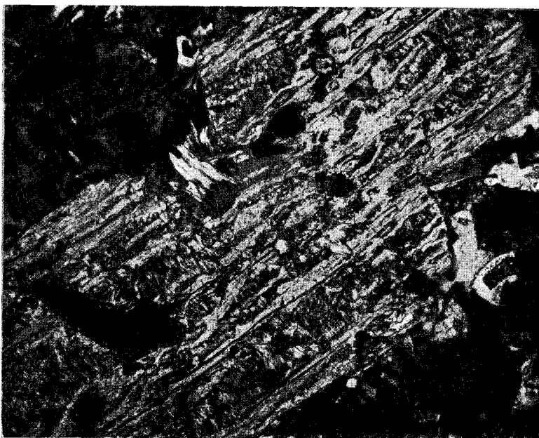
Abb. 13. Zweistufiger Abbau von Augit im Quarzporphyr. Höchstädt. Die Schuppen der Abbaustufe I liegen einheitlich parallel zur Längsachse der Pseudomorphosen (im Bilde von rechts oben nach links unten), die Schuppen der Abbaustufe II (Chlorite) liegen quer dazu. × Nicols, 90-fache Vergrößerung.
