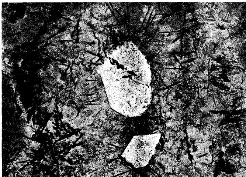
Abb. 9. Sphärolithischer Quarzporphyr (Johanneszeche). Im Kerne der parallel zum Fluidalgefüge gestreckten Sphärolithe liegen verglimmerte Plagioklase, umgeben von mikrofelsitischem Quarz-Feldspatgewebe mit skelettären Biotit-I-Individuen. Vergrößerung etwa 90-fach.
