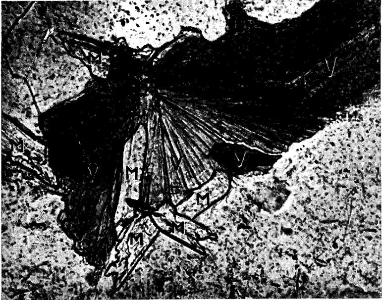
Bild 15. Muscovit-Granat-Gneis, bei Biengarten südwestlich Münchberg; 280 $\times$  Vergr. Vermiculit (V), die dunklen Garben der Abbildung und das große Scheit, parallel verwachsen mit Muscovit (M), die hellen Scheiter der Abbildung. Das große Vermiculit-Scheit ist pseudomorph nach Biotit (die Umwandlung von Biotit in Vermiculit ist an anderer Stelle zu beobachten). Muscovit und Vermiculit sind in diesem Fall gleich alt.
