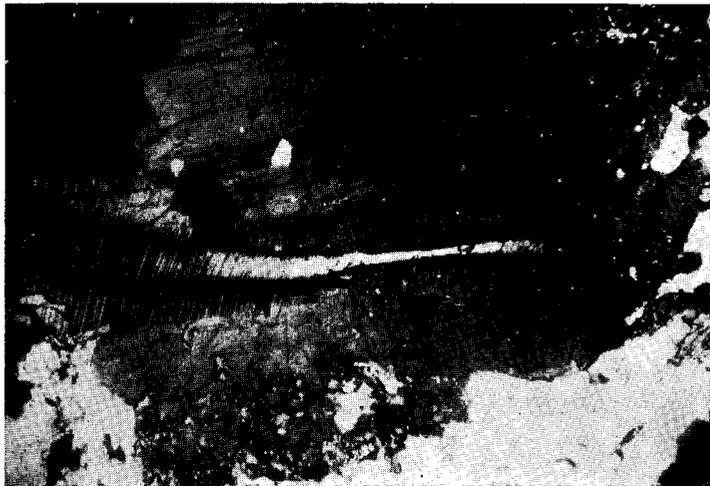
Bild 16. Pegmatit mit Nebengestein, südwestlich Münchberg; 35 $\times$  Vergr., Nicols gekreuzt. Im Nebengestein eines Pegmatits aufgesproßter Plagioklas mit verbogenen Albitlamellen (nähere Beschreibung s. Text S. 46).
