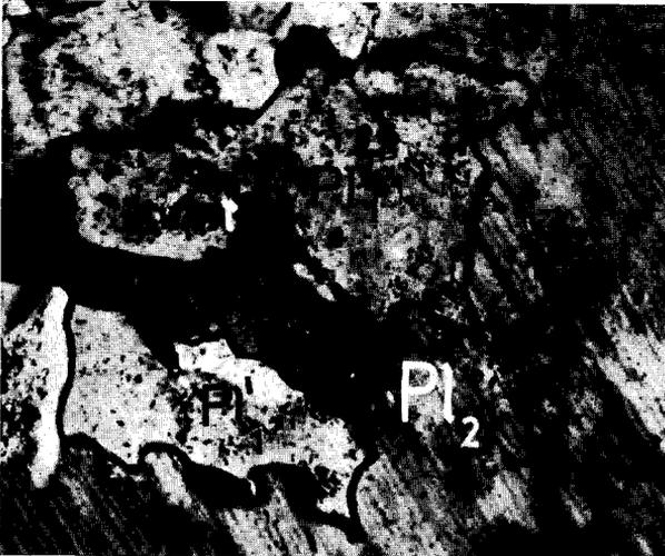
Bild 10. Flasrig-körniger Gneis, nordwestlich Friedmannsdorf; 225  $\times$  Vergr., Nicols gekreuzt. Stark von Erz getrüebter Plagioklas (Bildmitte) wird von einem Plagioklasgroßkorn verdrängt. Der „alte“ Plagioklas ist höher lichtbrechend als der neu aufsprossende. Dieser hat bereits Teile des „alten“ abgetrennt. Ein größeres Bruchstück ist im Bilde oben zu erkennen.
