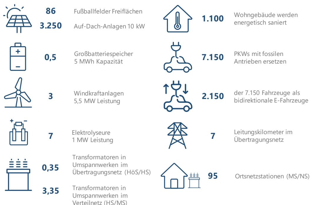
Abbildung 10-18: Die anhand der Ausbautzahlen des Mix-Pfades berechneten notwendigen Transformationsmaßnahmen pro Woche zur Erreichung der bayerischen Klimaziele im Jahr 2040 31
